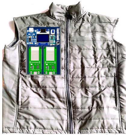
Gamar 3. Desain Rompi dengan Sensor Detak jantung dan Suhu
