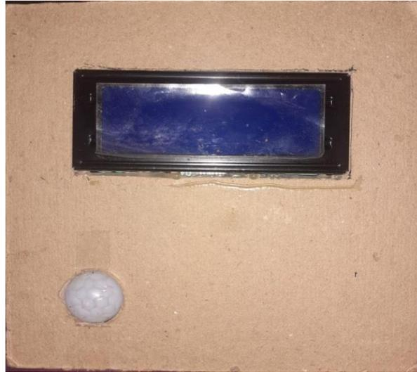
Gambar 7. LCD dan sensor PIR
