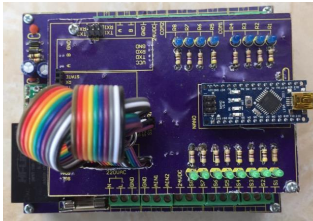
Gambar 5. Hasil Akhir Pembuatan Outseal PLC Berbasis Arduino Nano
