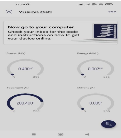
Gambar 6. Tampilan Tegangan Dan Arus Pada Aplikasi Blynk
