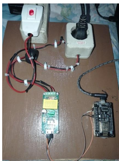
Gambar 3 Tampilan alat pengukuran PZEM
