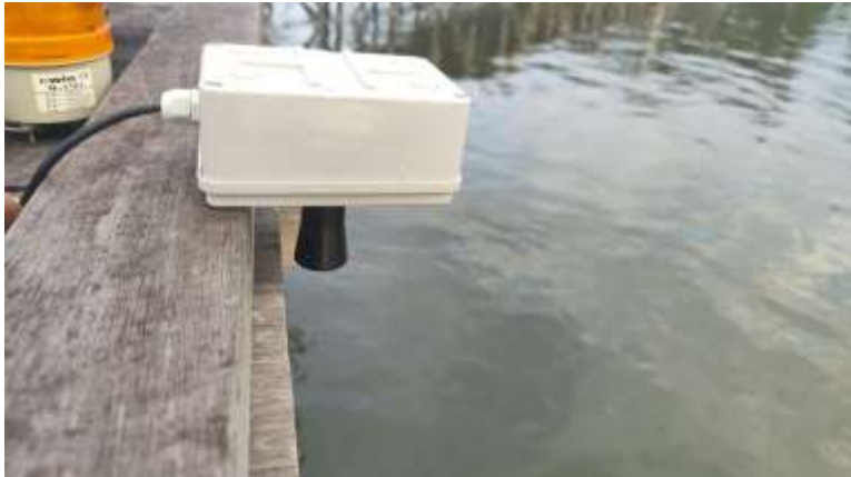
Gambar 5. Pengujian Sensor Muka Air Laut
