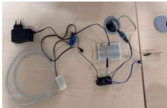
Gambar 6. Rangkaian sistem Smart Agriculture untuk tanaman selada berbasis IoT
